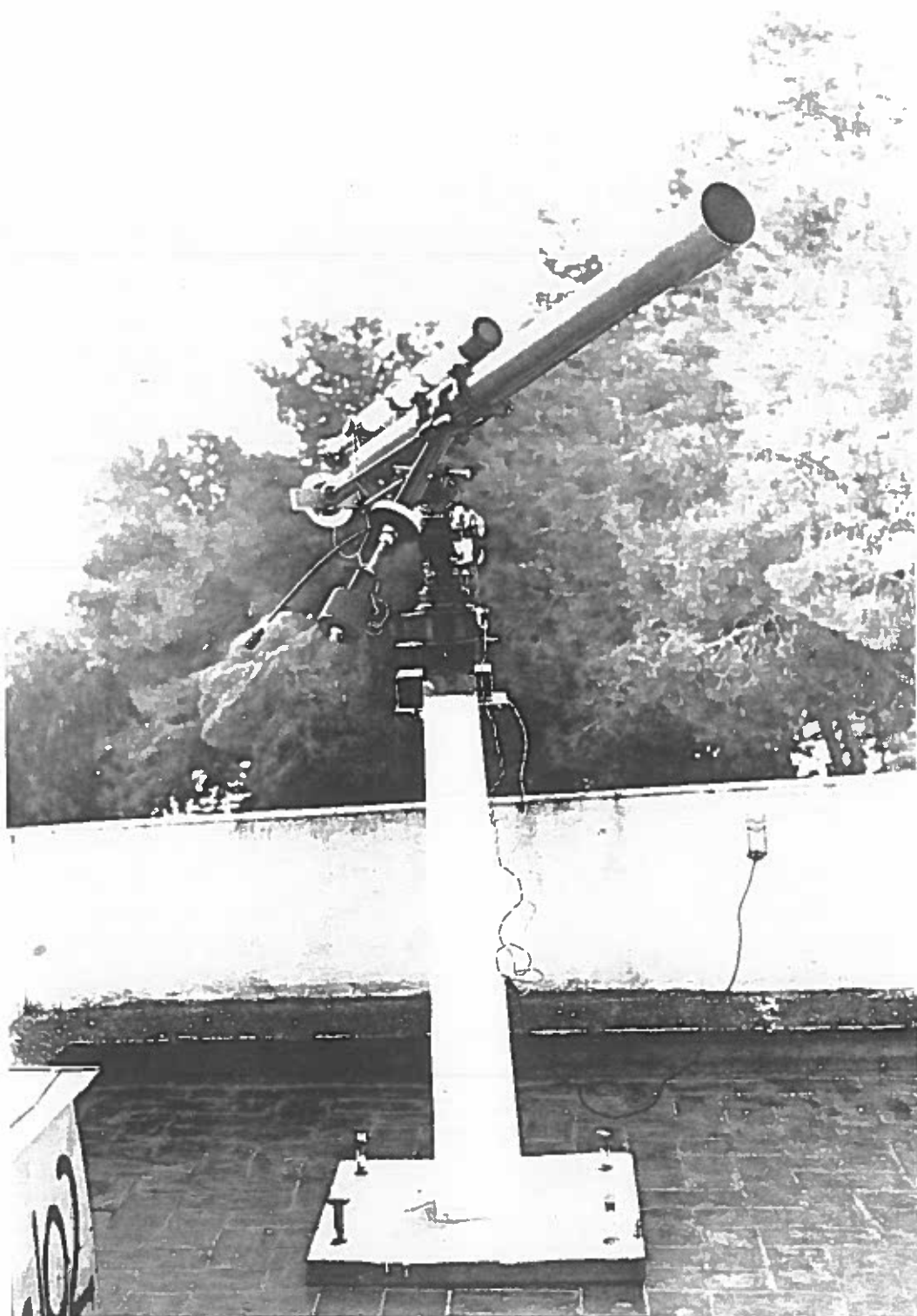
Aspecto general del R-102/1500mm en 1991 que poco recuerda al inicial. Nuevos accesorios han hecho necesario aumentar los contrapesos. Obsérvese el ocular micrométrico que se halla instalado en el portaocular. poco después de esta fotografía, un nuevo sistema de enfoque está a punto de sustituirlo.
